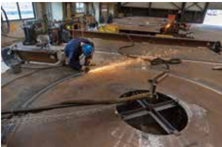
Productie van het (omgekeerde) brugval met robuuste draaipunten.
