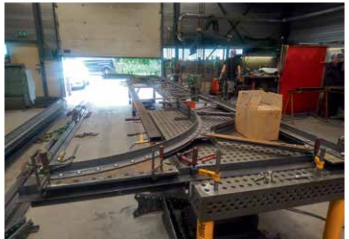
7. De lange tussenliggers zijn gereproduceerd en geklonken zoals voorheen.
